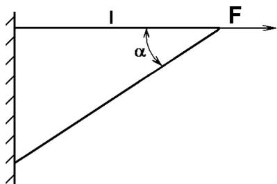
Определить перемещения концов стержней
