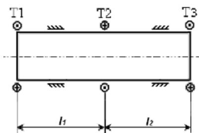
Определить углы закручивания вала
