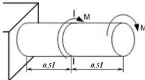
$$M = 16 \text{ кНм}, l = 2 \text{ м}, \text{ диаметр вала } d = 0,1 \text{ м}, G = 8 \cdot 10^{10} \text{ Па}$$
