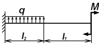
Построить эпюры внутренних силовых факторов для балки. Определить опасный участок.
