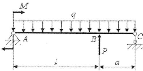
Определить номер стандартного двутавра из условия прочности по нормальным напряжениям.
